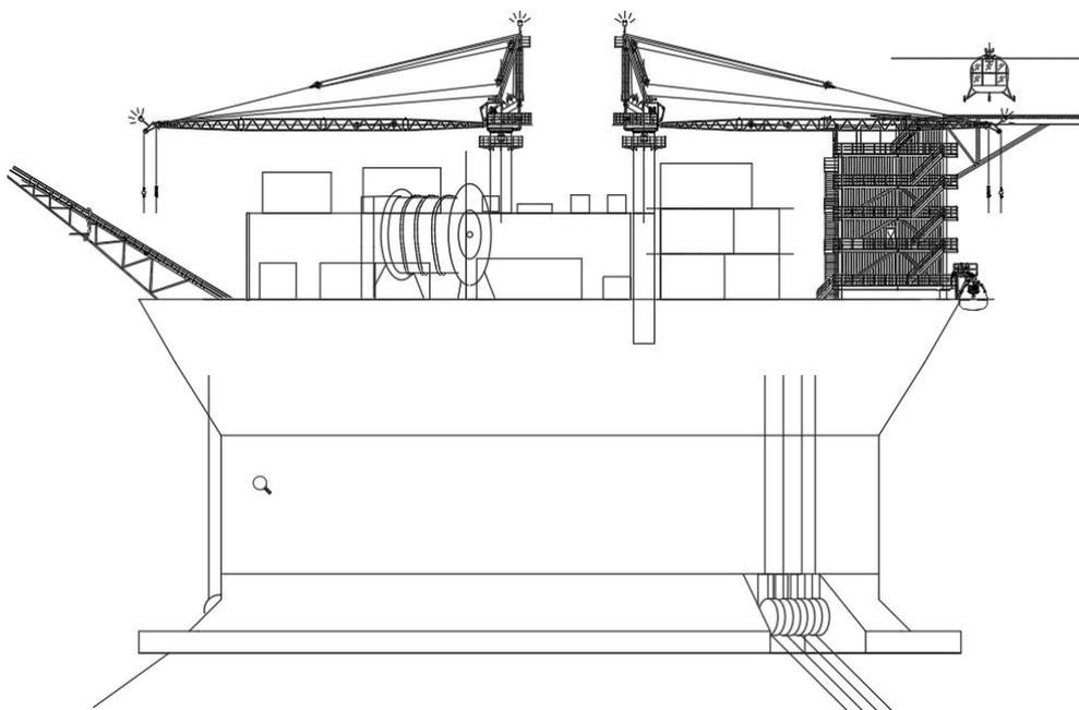
②动态管缆：采用系链缓波构型，通过配重块和浮力块来满足张力和弯曲半径的要求，设置系链和系链基础约束管缆运动，末端设置限位基础。动态管缆顶部悬挂在 FPSO 船底以下 2m 处，悬挂点距 FPSO 中心水平距离为 30m。动态管缆总长度为 950m，末端距悬挂点水平距离为 650m。系链为不可拉伸缆绳，水中重量可考虑为零。此次比赛中不考虑动态管缆顶部的抗弯加强器和系链处卡具结构。
